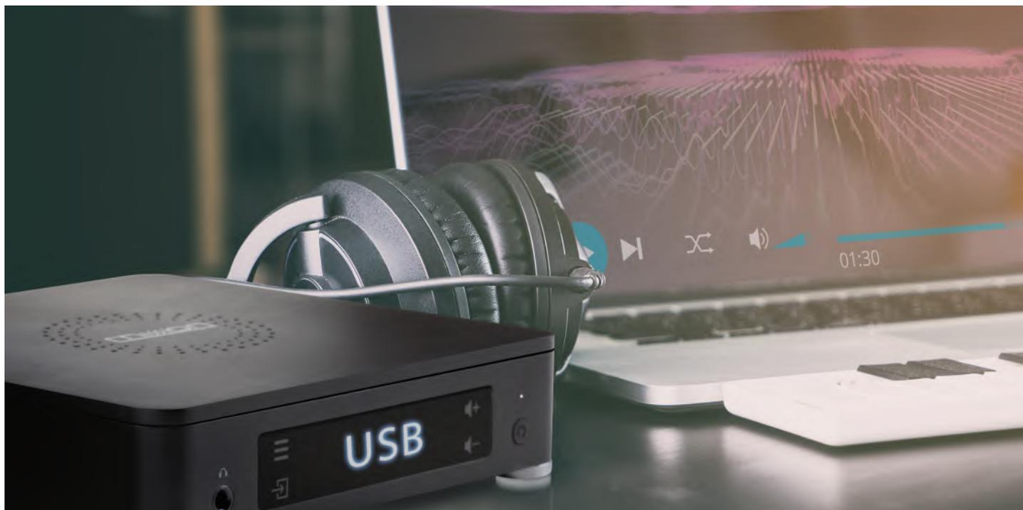
Incorpora un DAC ad alte prestazioni basato sul chip DAC ES9018K2M, della famiglia Sabre32 Reference. Per prestazioni a bassissimo rumore e un'elevata gamma dinamica, il chip ES9018K2M è accompagnato da circuiti proprietari per sfruttare al massimo l'architettura HyperStream a 32 bit della tecnologia ESS e il Time Domain Jitter Eliminator.
