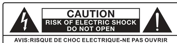
Questo lampo con il simbolo di una freccia all'interno di un triangolo equilatero ha lo scopo di avvisare l'utente della presenza di "tensione pericolosa" non isolata all'interno dell'involucro del prodotto che potrebbe essere di intensità sufficiente a costituire un rischio di scossa elettrica.
