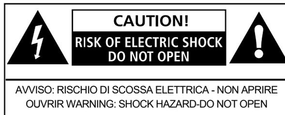
Questo simbolo di fulmine con punta a freccia all'interno di un triangolo equilatero ha lo scopo di avvisare l'utente della presenza di "tensione pericolosa" non isolata all'interno dell'involucro del prodotto che potrebbe essere di entità sufficiente a costituire un rischio di scossa elettrica.
