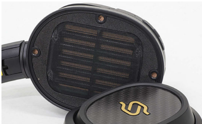
Il driver planare occupa tutta la superficie disponibile del padiglione.
