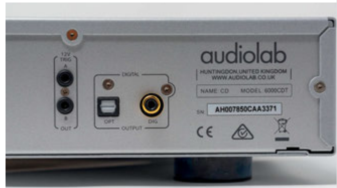
Sul pannello posteriore si trovano le due uscite S/PDIF RCA e ottica.
